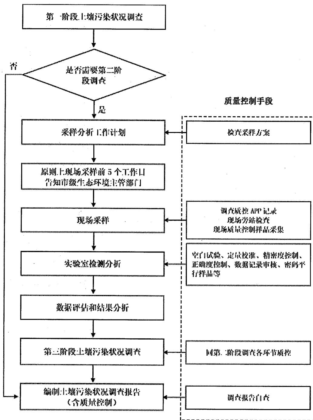
图 1 质量控制工作流程图
